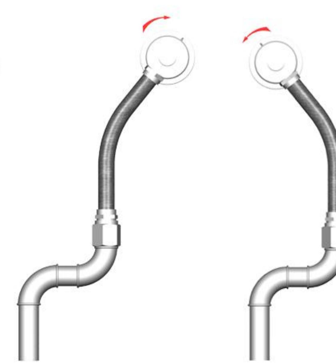
5. Hortumlar montaj sırasında burulmamalı ve eğilmemelidir. Gereken yerlerde boru bağlantı parçaları kullanılmalıdır.
