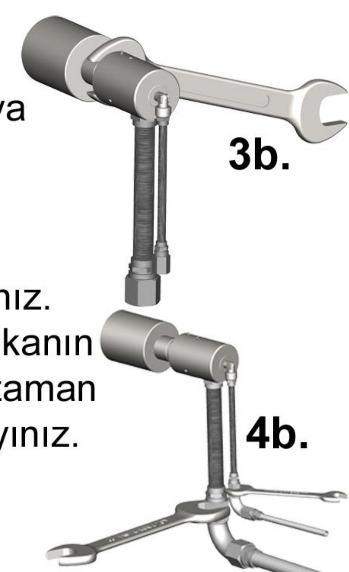
5. Montaj sonrası, döner bağlantı elemanın yumuşak bir şekilde döndüğünden emin olunuz. Salgılı dönmesi durumunda, söküp tekrar montaj yapınız.
