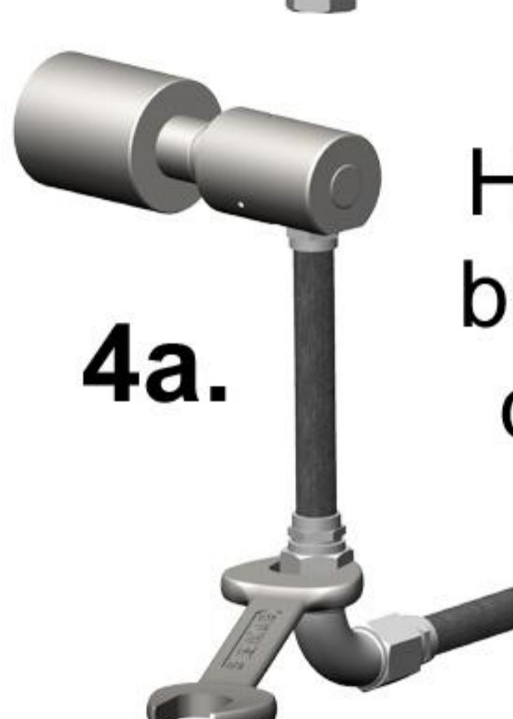
4. Hortumların dönüş yönünde eğim yapacak şekilde montajını yapınız. Hortumun sıkı olup olmadığı yada besleme vanaları açıldığında akışkanın basıncı ve sıcaklığı ile birlikte sıkı olmayacağı kontrol ediniz. Hiçbir zaman döner bağlantı elemanını direkt boruya rigid bir şekilde montaj yapmayın.
